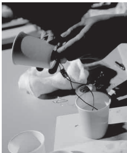
紙コップに注いだレモンティに電極を刺す
